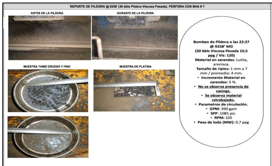
Figura 15. Morfología de los cortes lutita tamaño promedio 4,0 mm, infrayacente al intrusivo, pozo YRCA 15H (Reporte final de perforación Yuralpa Centro A-015H).
