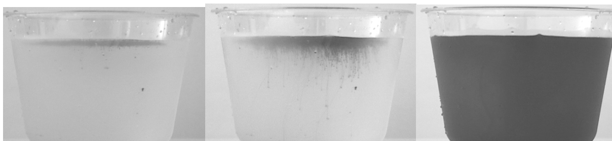
Figura 1. Fenómeno de "Salt Finger" visible en agua fresca (menor que 20°C) y Violeta de Metilo a temperatura ambiente. Izquierda: etapa inicial, centro: régimen transitorio (Salt Finger), derecha régimen estacionario (dilución).
